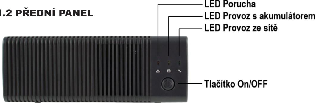
Jestliže je zdroj připojen, stiskněte tlačítko ON a zdroj bude pracovat v síťovém nebo akumulátorovém provozu, podle toho, zda bude napětí v síti dostupné. Opětovným stiskem tlačítka vypnete ovládání střídače, ale je zachována funkce dobíjení akumulátoru, pokud je přítomna vstupní síť.
